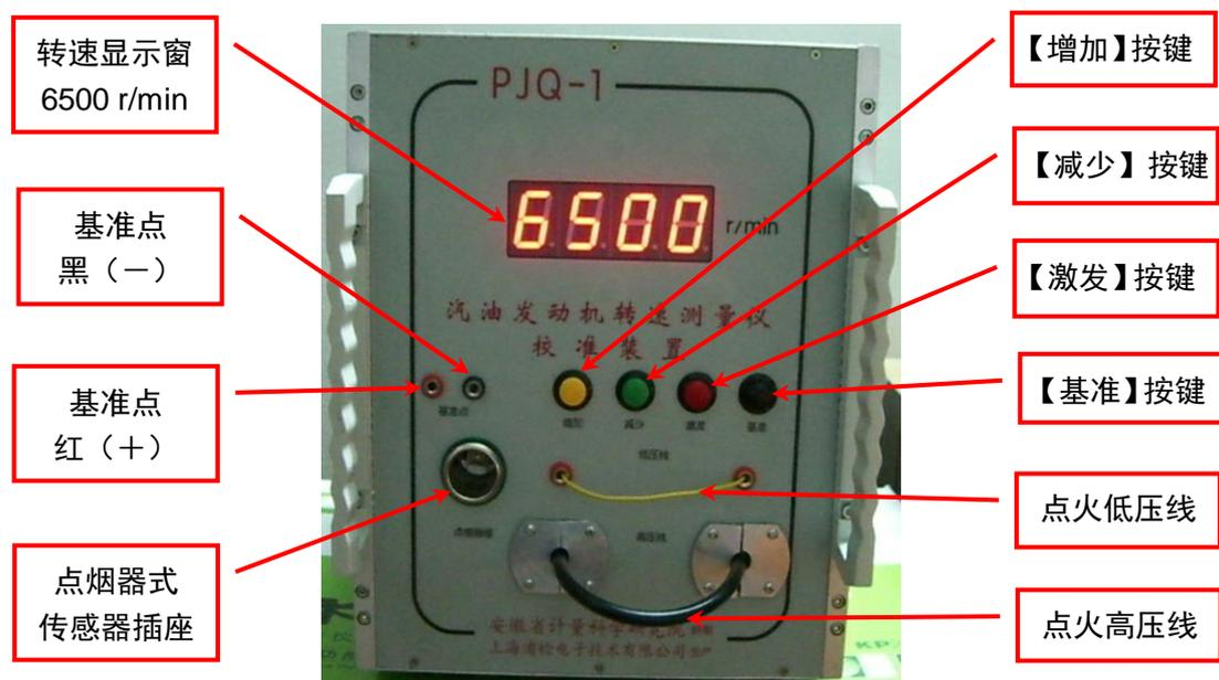
图 1 汽油发动机转速测量仪校准装置外形图
