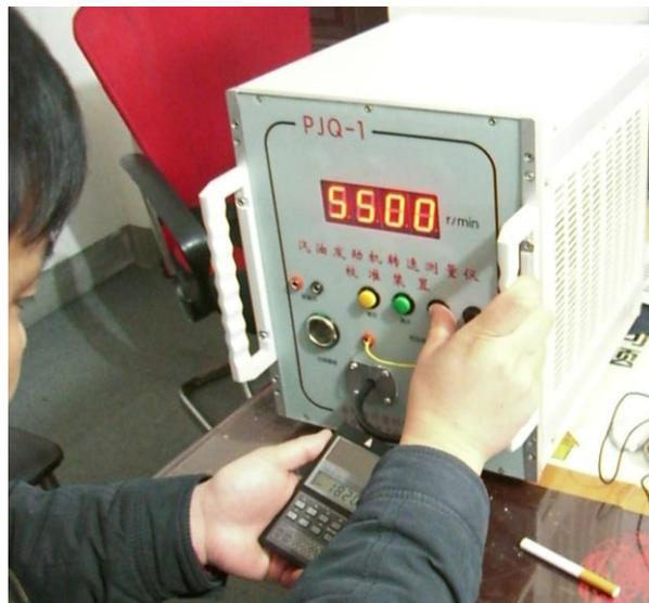
图3 汽油发动机转速测量仪的校准
