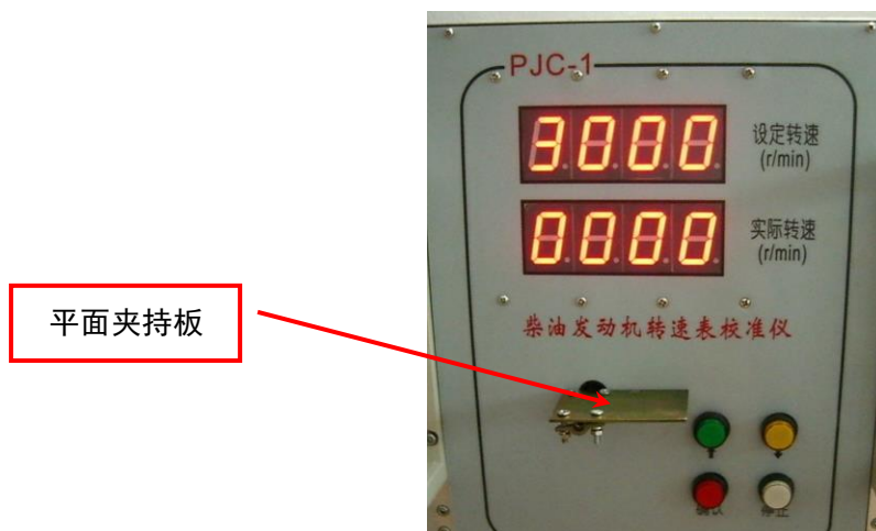
图5 校准平面式传感器时的装夹具
