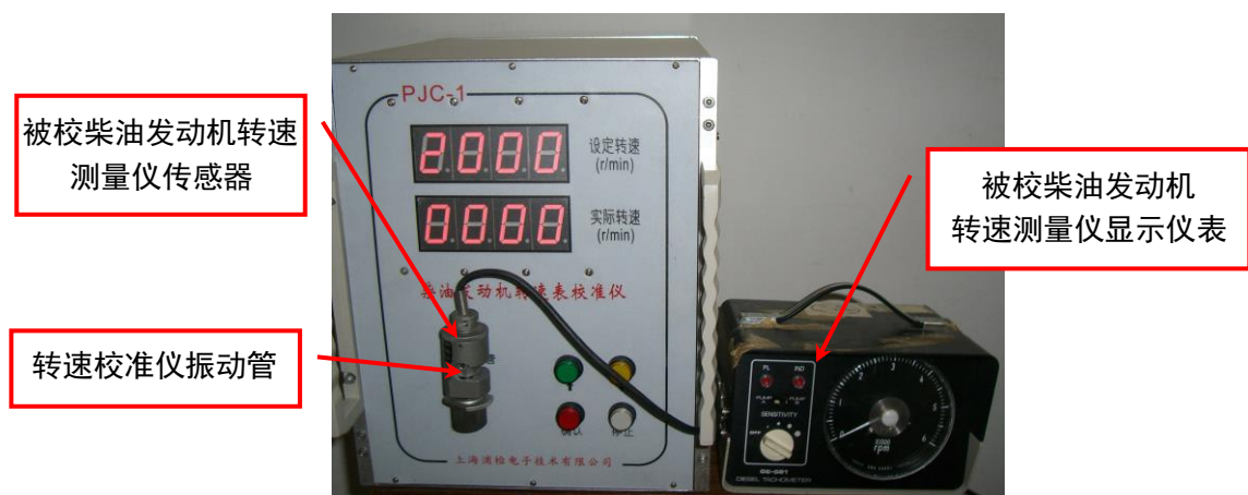
图 3 柴油发动机转速测量仪（指针式）校准安装图
