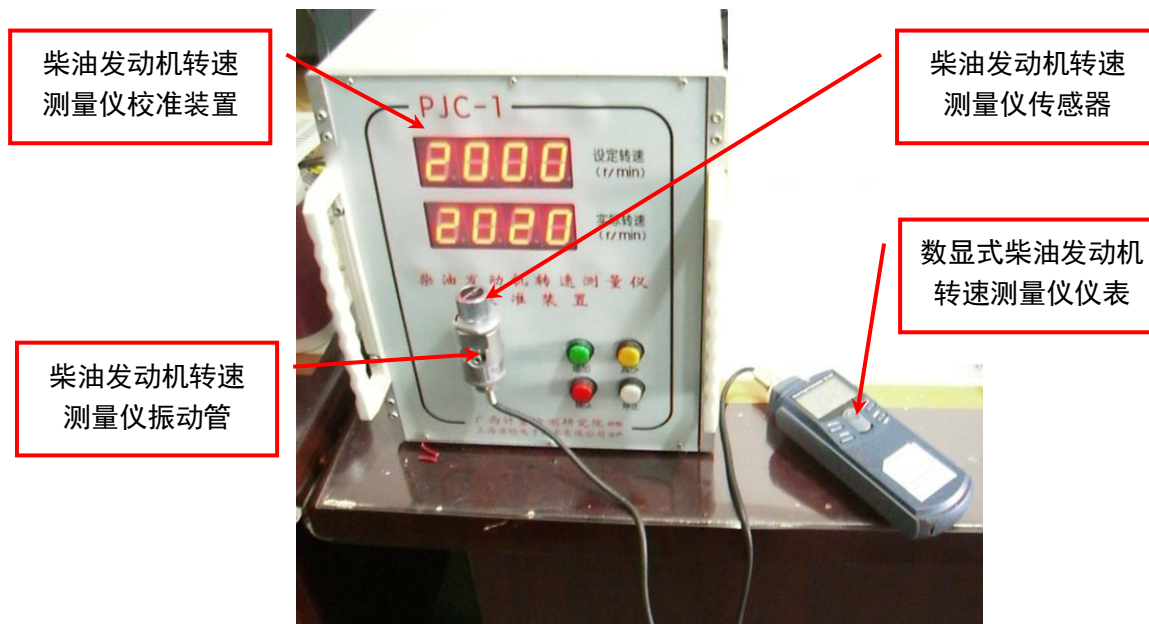
图4 柴油发动机转速测量仪（数显式）校准安装图
