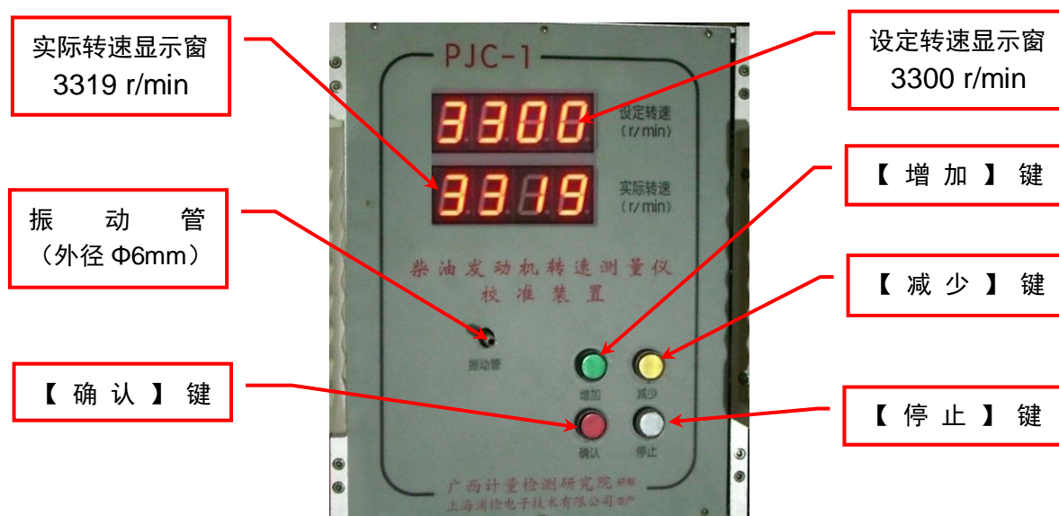
图 1 柴油发动机转速测量仪校准装置外形图
